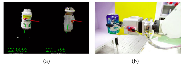
图6 (a) 基于VFH描述子的物体几何形态描述和 (b) 平行式二指手爪对可乐罐的抓取
